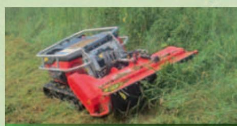
En raison de la suspension indépendante de la commande du robot, le Timan RC-1000 a toujours le contact parfait avec le sol et donc une transmission de puissance optimale.
